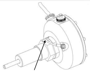
Earth conducting: section 1,5 mm<sup>2</sup> mini.
