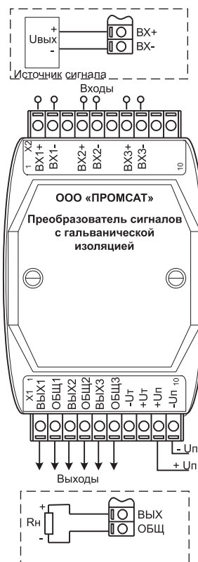
Схема подключения преобразователя PSA-01.03.23.XX.XX
